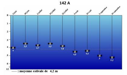
Une bonne estimation de la transparence moyenne estivale de l'eau a été obtenue par 9 mesures de la profondeur du disque de Secchi.
